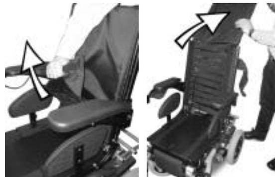
Para alterar a altura do encosto, deverá primeiro soltar as coberturas (A) da extremidade do tubo de suporte do encosto.
