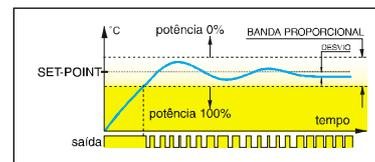
*Nota: o controle PID aqui exemplificado, foi considerado com lógica reversa (aquecimento). Para a lógica direta (resfriamento), em termos da potência de saída, o funcionamento é exatamente o oposto.*
