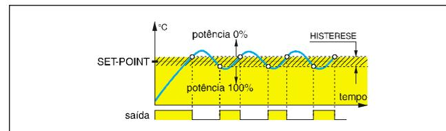
*Nota: o controle ON-OFF aqui exemplificado, foi considerado com lógica reversa (aquecimento). Para a lógica direta (resfriamento), em termos de potência de saída, o funcionamento é exatamente o oposto.*
