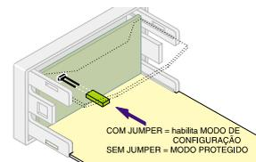
**Obs.: note que, caso o “jumper” não seja instalado, o MODO DE CONFIGURAÇÃO ficará TOTALMENTE INACESSÍVEL ao operador (MODO PROTEGIDO).**
