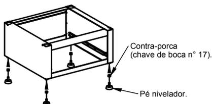
**Passo 2:** Com a ajuda de duas ou mais pessoas, levante cuidadosamente a lavadora e coloque-a sobre o pedestal, acomodando os pés da lavadora nos rebaios existentes na parte superior do pedestal.
