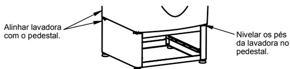
**OBSERVAÇÃO:** Caso o conjunto pedestal / lavadora apresente vibração excessiva, repita a operação de nivelamento dos pés da lavadora e do pedestal. Caso o processo de nivelamento não elimine a vibração, deve-se efetuar o travamento da lavadora no pedestal conforme indicado abaixo:
