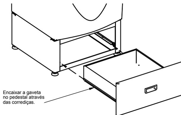
**Passo 5: Barulho e vibração excessivos podem ser prevenidos através do correto nivelamento do conjunto lavadora / pedestal sobre um piso SÓLIDO e do correto nivelamento dos pés.**
