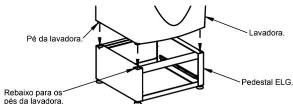
**Passo 3:** Alinhe os lados da lavadora com os lados do pedestal e nivele os pés da lavadora com a parte superior do pedestal.
