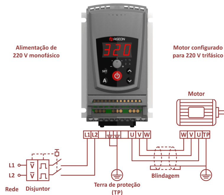
Figura 7-1 - Conexões elétricas de potência
