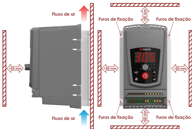
Figura 6-1 - Fixação do inversor
