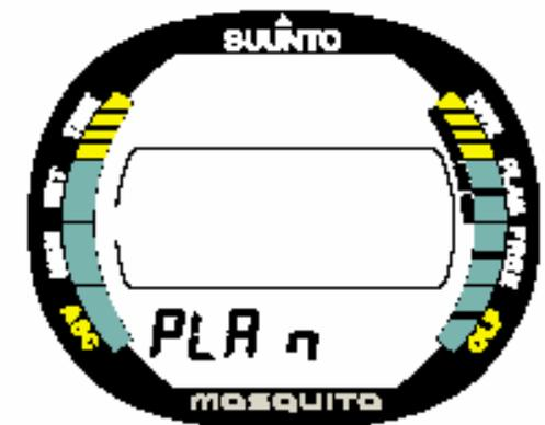
Fig. 3.8. Planejamento de Mergulho. O modo de planejamento é indicado pelo texto **PLAN** e o modo indicador.
