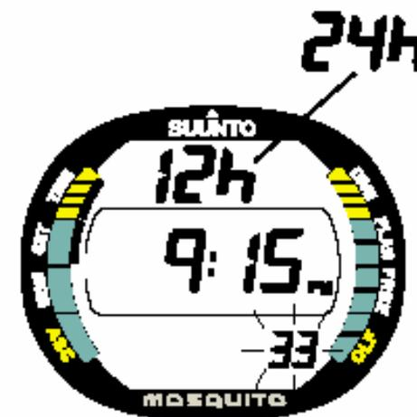
Fig. 4.3. O modo de ajuste de Hora é ativado e os dígitos dos segundos começam a piscar (Pág I)
