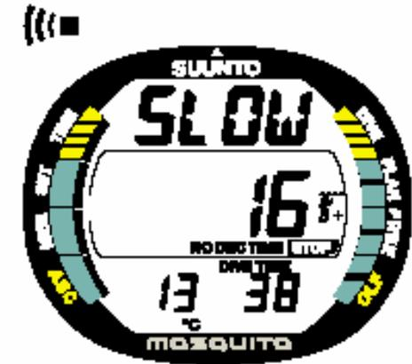
Fig. 3.15. Indicador de Velocidade de Subida. O texto **SLOW** e quatro segmentos da barra lateral são mostrados acompanhados de um sinal sonoro. A vel. de subida é maior que 10 m/min (33 ft/min). Esse é um aviso para se diminuir a velocidade de subida. O texto **STOP** sinaliza que uma parada de segurança obrigatória quando você chegar a uma profundidade de 6 m (29 ft).
