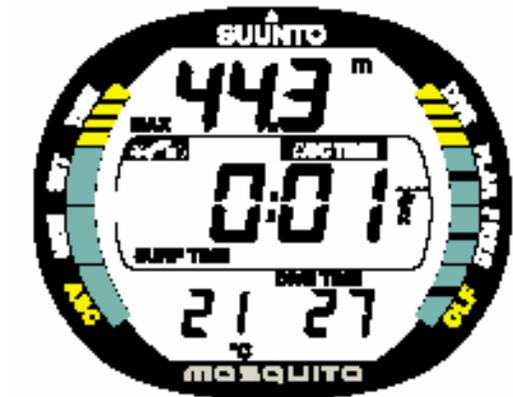
Fig. 3.26. Mostrador de Superfície após uma descompressão violada. O ícone **ASC TIME** indica que você violou a profundidade de teto por mais que 3 minutos. O mostrador alternativo indica que você não deve mergulhar por pelo menos 48 horas.
