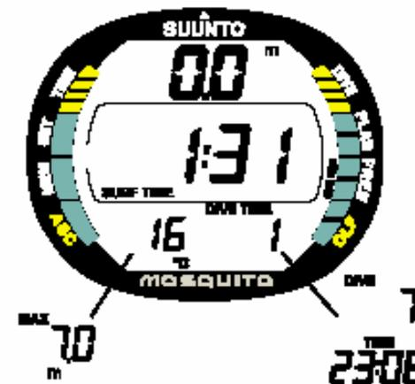
Fig. 3.33. Mostrador de Superfície após um mergulho Livre. A janela central mostra o tempo de superfície
