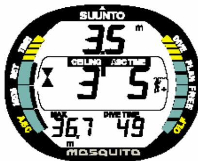
Fig. 3.19 Mergulho Descompressivo na zona de teto. Duas setas apontando uma para outra (ampulheta). Você está no melhor patamar de profundidade (3,5 m / 11 ft) e o seu tempo mínimo de subida é de 5 min.
