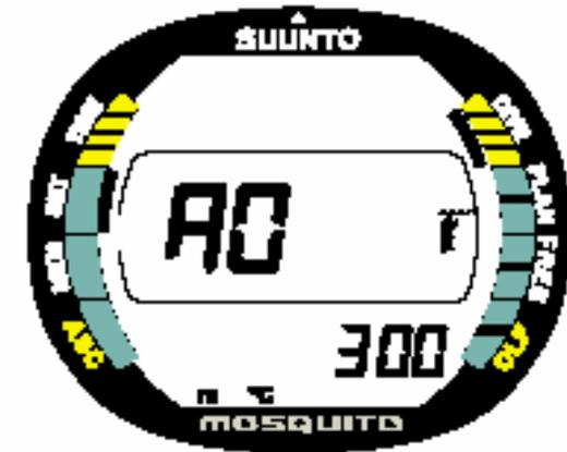
Fig. 4.14. Modo da Ajuste de Altitude.
