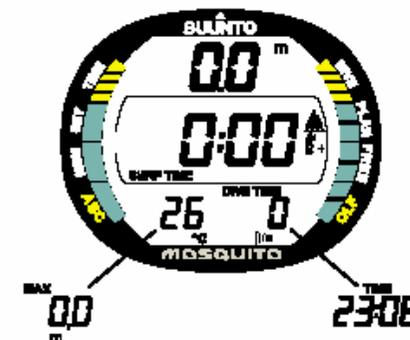
Fig. 3.4. Inicialização III. Modo de Superfície (Ar). A profundidade e o tempo de mergulho é igual a zero. Pressione os botões + ou - para ativar as informações alternativas de profundidade máxima e a hora atual
