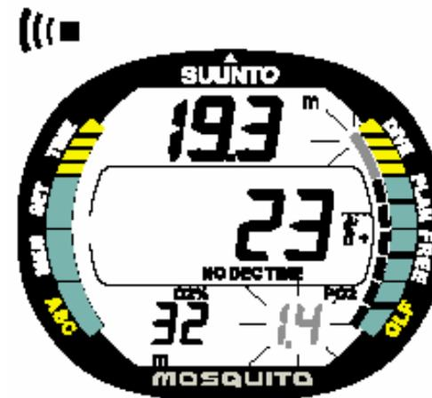
Fig. 3.23. O mostrador com a pressão parcial de Oxigênio e a **OLF**. Se a pressão parcial do Oxigênio é maior que 1,4 bar ou o valor estipulado, ou se a **OLF** chegou a um valor de 80 % do seu limite, o último segmento do gráfico de barras irá piscar, acompanhado de um aviso sonoro. Quando a **OLF** chegar a 100 %, todos os segmentos do gráfico de barras irão piscar. Se a **OTU** for maior que a CNS, o segmento inferior irá piscar.
