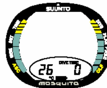
Fig. 3.6. Aviso de Bateria Fraca. O símbolo de bateria indica que a bateria está fraca
