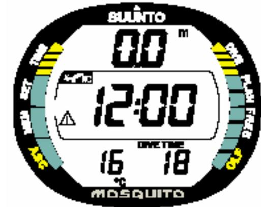
Fig. 3.25. Mostrador de Superfície. As informações alternativas incluem o tempo de espera para o vôo.
