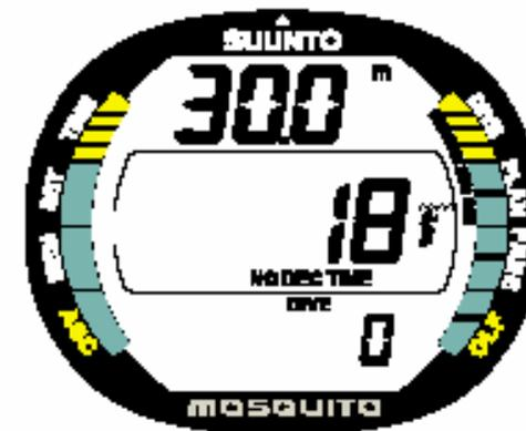
Fig. 3.9. Planejando. O limite não descompressivo a 30 m (100 ft) é de 18 min com P0/A0.
