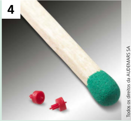
Micromoldagem por injeção: pesos de injeção minúsculos pelo módulo de micromoldagem.
