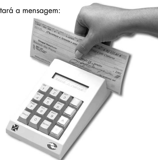
Essa mensagem ficará no visor, demonstrando que o equipamento encontra-se ligado e pronto para operação. Passe o cheque na fenda do terminal sempre da esquerda para a direita, com a linha de código virada para baixo.
