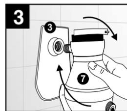
Com o aparelho desmontado e o Niple Externo (2) já instalado, encaixe a Tampa traseira (3), aplique fita veda rosca no Niple de entrada (8) e rosqueie o Bojo completo (7), **"utilizando apenas as mãos, sem o auxílio de ferramentas!"**
