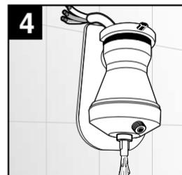
Depois de fixado o aparelho, abra novamente o registro, deixando correr água, sem ainda fazer a conexão elétrica, para encher o Bojo do aparelho e evitar danos à Resistência quando o aparelho for acionado pela primeira vez. Este procedimento também é fundamental para verificar se há ocorrência de algum vazamento (principalmente na conexão junto a parede).
