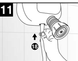
Encaixe a extremidade da Mangueira (18) até o aperto final, certificando-se que a mesma esteja fixada adequadamente no Tubo de Conexão (16), em seguida instale o Chuveirinho Manual no Suporte (19), de acordo com o gabarito da ilustração do passo 9.
