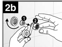
**2b** - Se a coluna de água for maior do que 5 metros (50kpa), mantenha o Redutor de Vazão no Niple Externo (2). Aplique fita veda rosca no Niple Externo e rosqueie-o firmemente na conexão da parede.
