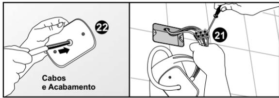
Passo o conjunto (Acabamento + cabos + aterramento) da Ducha JD FAME pela Placa (22). Ligue os cabos, utilizando o Conector (21) que deve ser bem apertado e colocado dentro da caixa de derivação. Tampe a caixa com a Placa e (22) parafuse-a.
