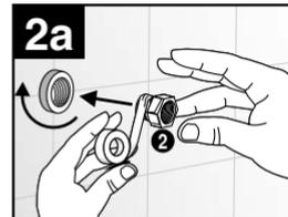
**2a** - Se a coluna de água for entre 1,5 e 5 metros, retire o Redutor de Vazão (1) do Niple Externo (2). Aplique fita veda rosca no Niple Externo e rosqueie-o firmemente na conexão da parede.
