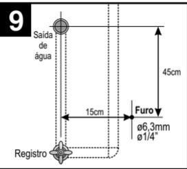
Siga as dimensões do gabarito da ilustração, para instalar o Suporte do Chuveirinho Manual (19) e para fixar as Buchas use brocas de  $\phi 6,3\text{mm}$ , ou  $\phi 1/4"$ , tomando cuidado para não perfurar o encanamento.
