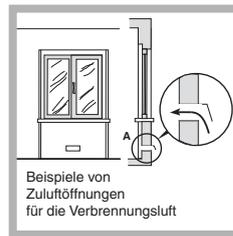
Das System kann mittels eines Belüftungsschachtes, mit Luftaufnahme direkt aus dem Freien, mit einem Nutzquerschnitt von mindestens 100 cm<sup>2</sup> verwirklicht werden, der so ausgelegt sein muss, dass ein unabsichtliches Verstopfen vermieden wird.
