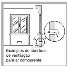
O sistema pode ser realizado capturando o ar directamente desde a parte externa do edifício através de um tubo de pelo menos 100 cm<sup>2</sup> de secção útil que não se entupa acidentalmente.
