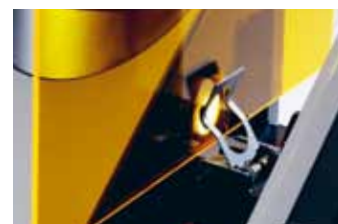
Medição de transmitância de sólidos
