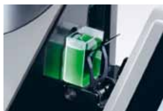
Medição de transmitância de líquidos
