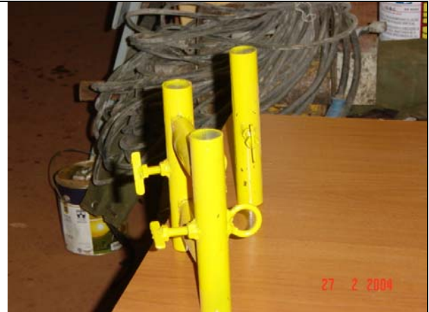
Figura 47 – Vista lateral do componente criado pela empresa C7 para maior segurança dos operários em serviços em beirada de laje na fase de estrutura
