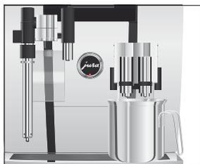
Ao ligar a GIGA, o processo de lavagem é solicitado automaticamente e ativado pulsando o Rotary Switch
