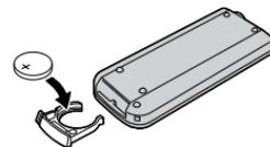
4 將電池托架插入遙控器，直至聽到“哢嗒”的就位聲。
