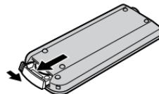
2 從電池托架中取出紐扣型鋰電池。
