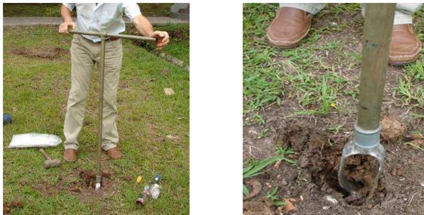
Figura 10 – Uso do trado holandês para coleta de amostras de solo a granel
