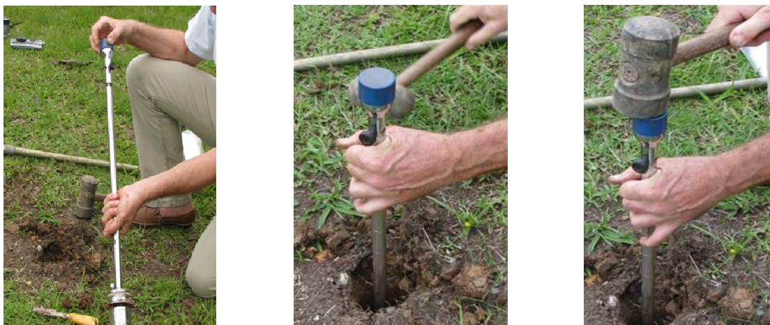
Figura 20 – Coleta de segunda amostra indeformada de solos–30 cm a 50 cm.
