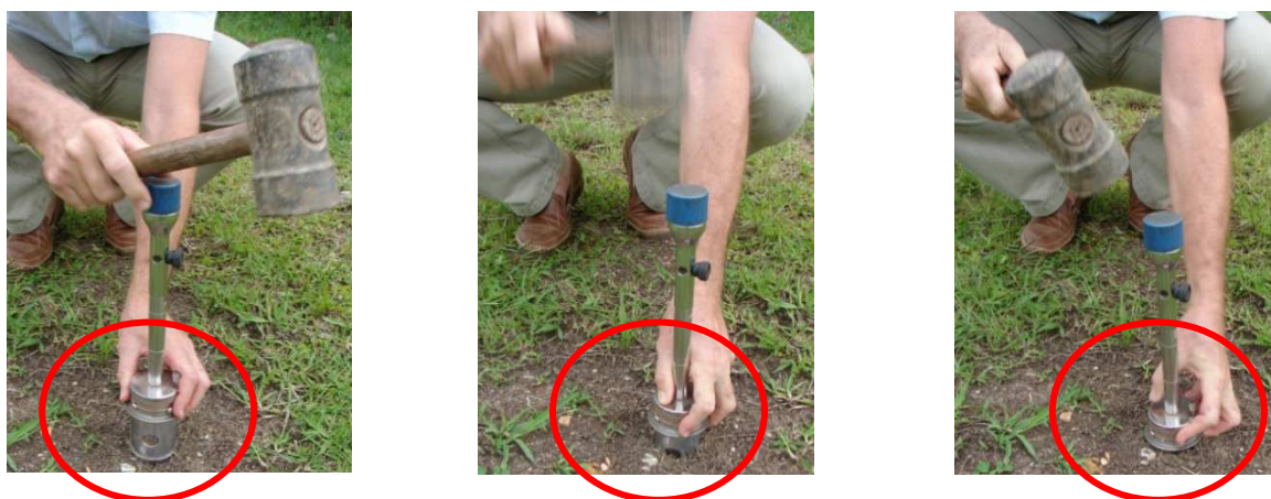
Figura 15 – Procedimentos iniciais para coleta de amostra indeformada de solos – 0 a 20 cm.
