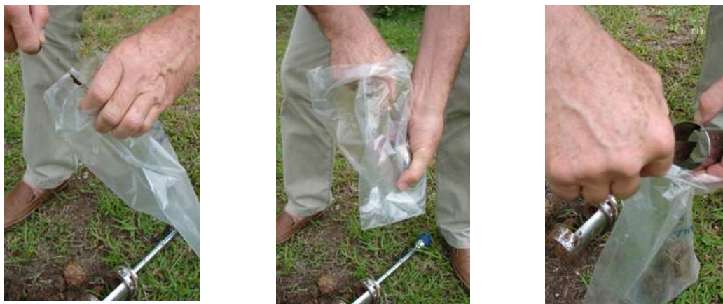
Figura 18 – Procedimentos finais para amostra indeformada de solos – 0 a 20cm
