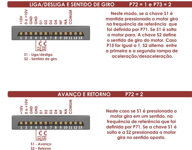
Figura 9-2 - Opções de comando através dos bornes de controle
