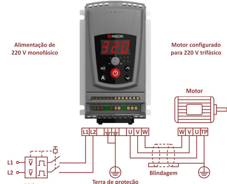
Figura 6-1 - Conexões elétricas de potência
