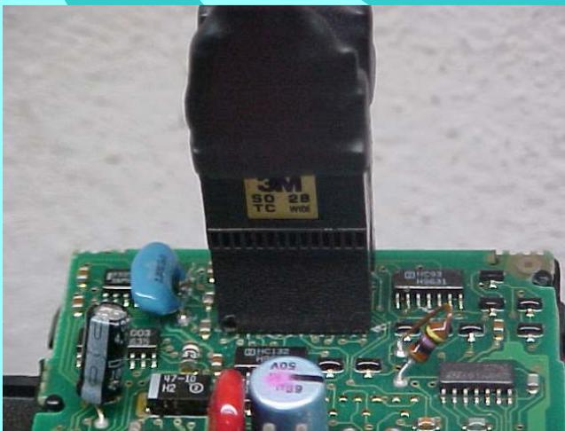
Vizualização mais ampliada da aplicação da Pinça Soic 8 no Microprocessador
