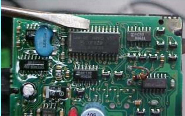
Utilizando a chave de fenda para limpeza das pernas do Microprocessador , para melhorar o contato da Pinça Soic 8
