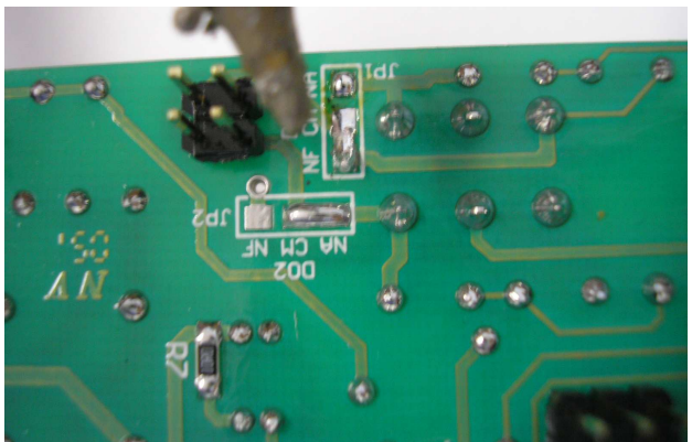
Figura A.5 – Coloque a solda entre os contatos NF CM
