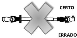
✓ A não observação deste detalhe aparentemente simples, resultará em grandes vibrações, provocando um desgaste prematuro do conjunto.
