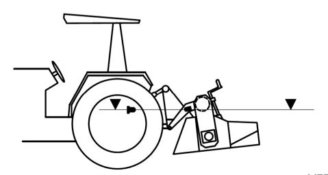
✓ Coloque lado a lado os dois eixos (macho e fêmea) e verifique se em cada extremidade existe uma folga de pelo menos 3 cm, não existindo a folga, marque e recorte os dois extremos no comprimento adequado;
