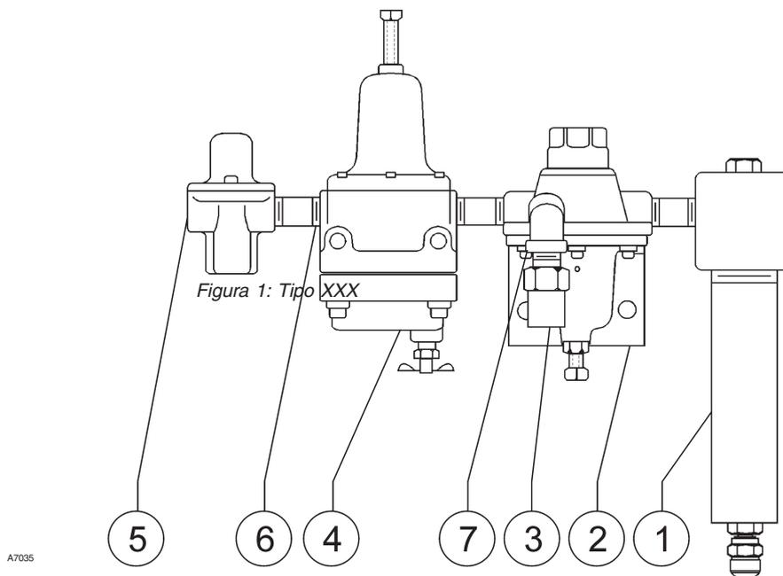
Figure 1. Sistema de Alimentação de Instrumentos Tipo 1367
