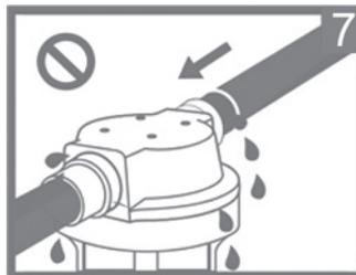
7 - Em caso de vazamento, verifique as conexões e o aperto do copo do filtro. NÃO UTILIZE fita veda-rosca na tampa do filtro.
