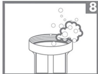
8 - Faça rotineiramente uma limpeza no copo do filtro. Utilize apenas água e sabão neutro. Evite materiais abrasivos.
