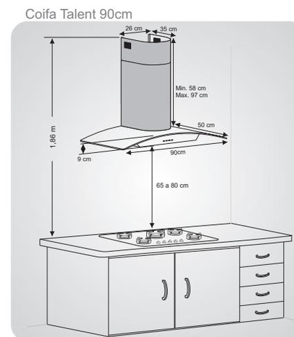
Existem duas possibilidades de instalação da Coifa Talent FISCHER, conforme segue no desenho:
