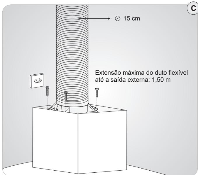
c) Fixar a conexão para o duto flexível com os parafusos e encaixar o duto plástico flexível (**SOMENTE NO MODO EXAUSTOR**).
