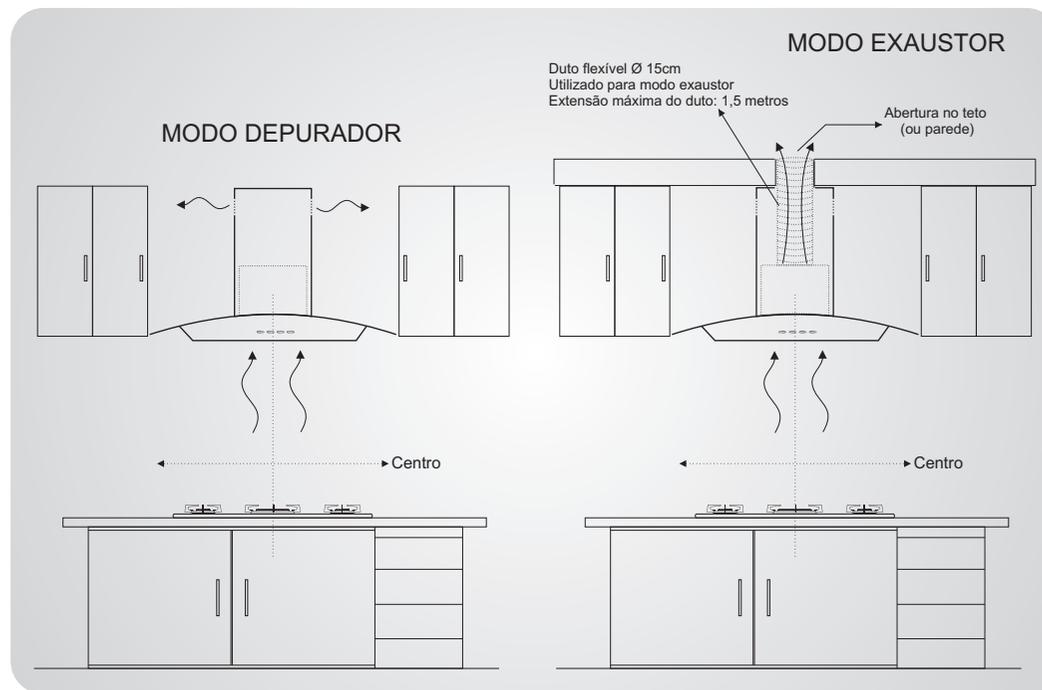
NOTA: Para fixação do produto, centralizar a linha de centro da coifa com o centro do fogão. Com uma trena, achar a altura entre o fogão e a base da coifa, conforme indicado neste manual (65 a 80 cm). Verificar se a altura da coifa até o teto não é superior a altura máxima do duto de inox (vide desenho pág. 07).
