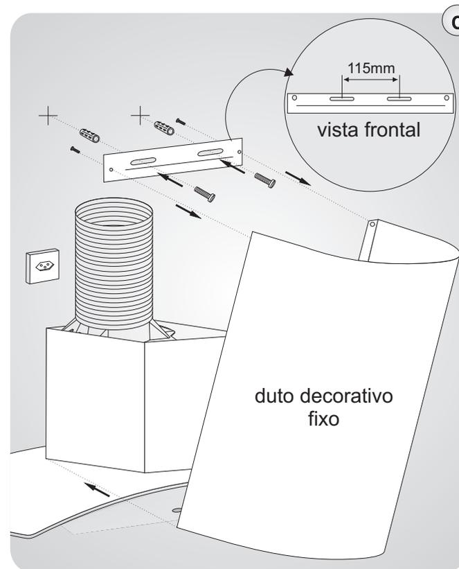
e) Conectar o produto à rede elétrica. Encostar o último suporte rente ao teto (onde o duto deslizante ficará encostado), e fixá-lo com os parafusos e buchas. A próxima etapa é passar o duto deslizante por dentro do duto fixo e parafusá-lo no suporte (detalhe x).
