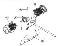
A seta na caixa de engrenagem indica o sentido de rotação. A caixa de engrenagem deve ser colocada conforme ilustrado.
