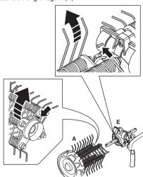
2 Apertar o rolo do separador de musgo com o pino ranhurado (B) no orifício **exterior** do eixo.
