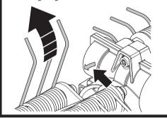
Pressione o separador de musgo do lado esquerdo (A) para dentro do eixo motriz do lado esquerdo da caixa de engrenagem (E).
