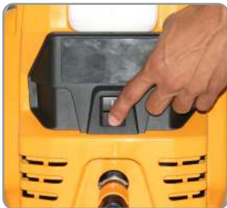
**1** Ao terminar o serviço de limpeza ou para interrupções prolongadas, desligue o equipamento posicionando o interruptor na posição **0**.
