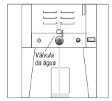
Coloque um recipiente sob a saída da válvula da água, abra a mesma e retire toda a água com os resíduos, efetuando posteriormente a limpeza da cuba com água quente e sabão ou detergente neutro.
