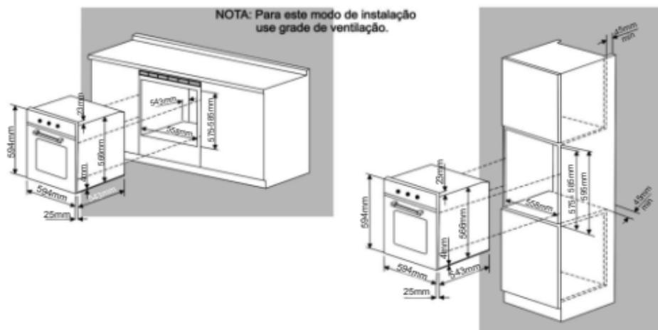
Segue abaixo ilustração de embutimento afim de assegurar uma boa ventilação no painel traseiro. Abertura de 45x560mm.
