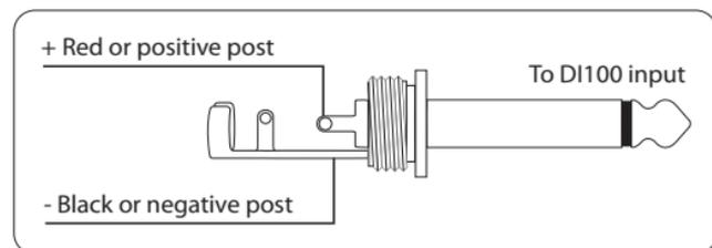
Fig. 2.3: Ligação a uma saída de amplificador
