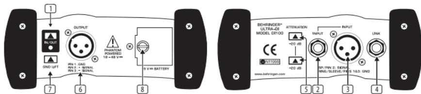
Fig. 1.1: Parte frontal & parte posterior da D1100
