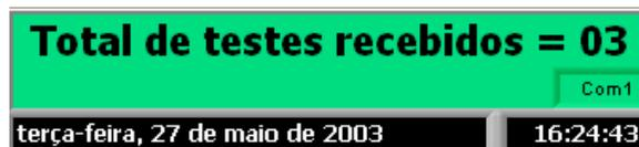
Neste local, serão dadas as indicações a respeito da comunicação com o Analisador e indicará quantos testes foram descarregados ou se houve alguma falha de comunicação. Na parte inferior, indica qual porta de comunicação está sendo utilizada para a comunicação e esta pode ser alterada pelo menu de funções, que será explicado adiante.
