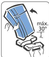
Retirar a Base da Embalagem Incline cuidadosamente o Refrigerador para um dos lados. Com a ajuda de outra pessoa quebre a base com as mãos. Incline o Refrigerador para o outro lado e retire o restante da base. Leia atentamente as etiquetas orientativas e este manual e retire as fitas adesivas e as espumas de todas as prateleiras/gavetas.
