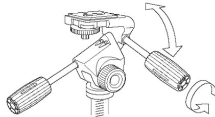
3. Solte o punho de inclinação vertical para ajustar o nível. A cabeça da bandeja é especialmente lubrificada para movimentos suaves.
