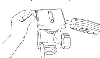
1. Tanto o parafuso de suporte de 1/4" como o de 3/8" são fornecidos. O parafuso não utilizado pode ser armazenado ao lado da plataforma da câmera.
