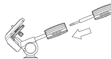
Remova o Punho de Inclinação Vertical da Cabeça da Bandeja, e parafuse-o na parte de trás do Punho de Inclinação & Panorama.
