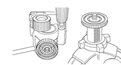
A cabeça é instalada ao parafusá-la na haste com rosca 3/8" da coluna central.
