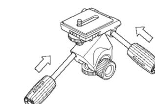
Os Punhos do Panorama são instalados como mostrado com o punho da esquerda para o movimento de Panorama e Inclinação e o punho da direita para Inclinação Vertical. Ambos os punhos são iguais. Você pode instalá-los de qualquer lado.
