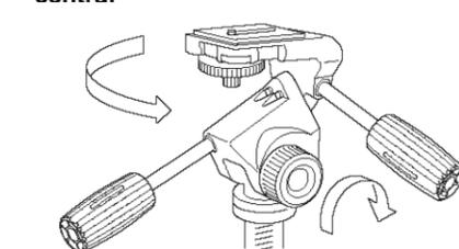
Trave a Maçaneta de trava do Panorama bem firme. Segure o punho do panorama e gire a cabeça inteira no sentido anti-horário para soltar. Então solte a maçaneta de trava do panorama e será fácil de desparafusar a cabeça ao rodar a base.
