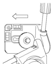
2. Remova o parafuso de suporte pela parte larga do trilho de suporte. É uma boa ideia apertar a maçaneta de trava da câmera quando a câmera não estiver presa para prevenir a perda dos parafusos de suporte.
