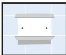
2- Fixe o suporte na parede usando bucha e parafuso ou fita dupla-face;
