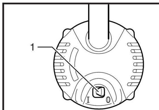
Para ligar a Tupia, mova a alavanca do interruptor para a posição I (Ligado). Para desligar, mova a alavanca do interruptor para a posição O (Desligado).
