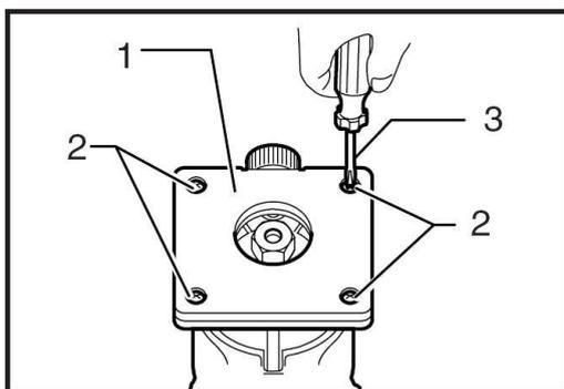
Em seguida, fixe reapertando os parafusos.
