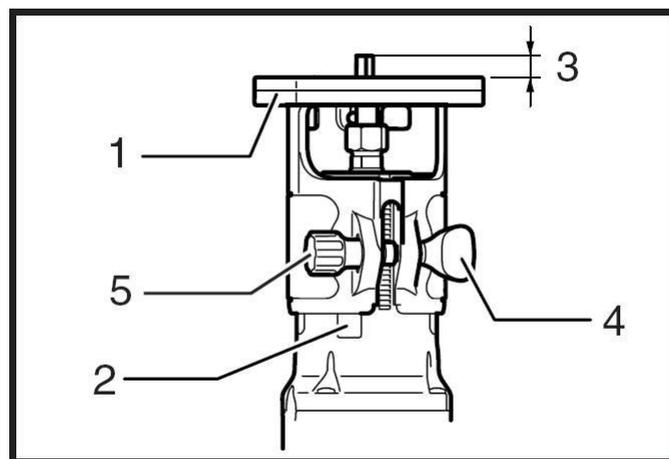
Para ajustar a profundidade, solte o manípulo de fixação (4) e mova a base da ferramenta para cima ou para baixo conforme o desejado na escala (2), girando o manípulo de ajuste (5). Após o ajuste, aperte o manípulo de fixação (4) garantindo firmeza à base (1) da ferramenta.
