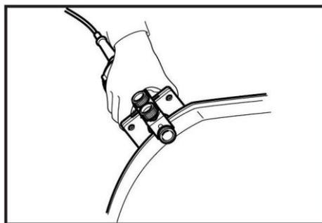
Para instalar esta guia sobre a base da Tupia (veja figura abaixo) utilize o manípulo (1). Afrouxe o manípulo (3) e ajustar a distância entre o bit e a guia rodando o manípulo (2) (1 mm por volta). Chegando até a distância desejada, aperte o manípulo (3).
