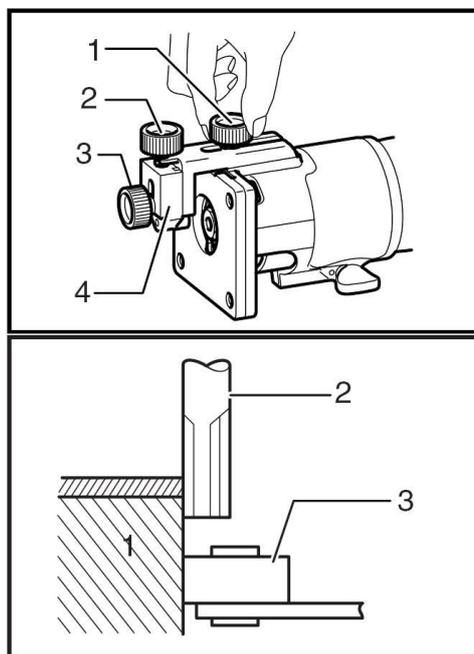
Durante o corte, mova a ferramenta com o rolamento (3) passando pela lateral da peça de trabalho (1).
