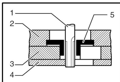
**NOTE:** A peça de trabalho vai ser cortada um tamanho ligeiramente diferente do gabarito. Permita para a distância (X) entre a fresa e o exterior da guia bucha. A distância (X) pode ser calculada usando a seguinte equação:
