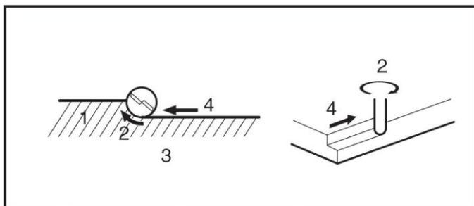
Defina a base da Tupia sobre a peça a ser cortada sem que o bit entre em contato com a peça.
