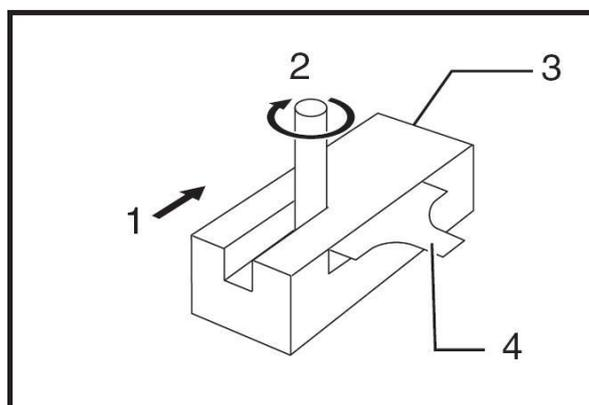
**ATENÇÃO:** O corte excessivo pode causar sobrecarga do motor ou dificuldade em controlar a ferramenta. A cada passe, a profundidade de corte não deve ser superior a 3 mm. Quando você quiser cortar sulcos com mais de 3 mm de profundidade, faça vários passes com as configurações de bit progressivamente mais profundas.
