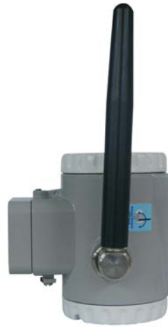
Figura 1.5 – Posição correta da antena com equipamento na horizontal
