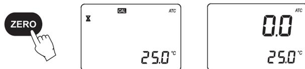
4. Absorva cuidadosamente o padrão de água ZERO com um tecido suave. Tenha cuidado para não riscar a superfície do prisma. Limpe a superfície completamente. O instrumento está pronto para a medição da amostra.
