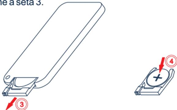
4. Em seguida substitua bateria pela nova, com o lado + (positivo) voltado para cima conforme a seta 4 e insira novamente no controle remoto.
