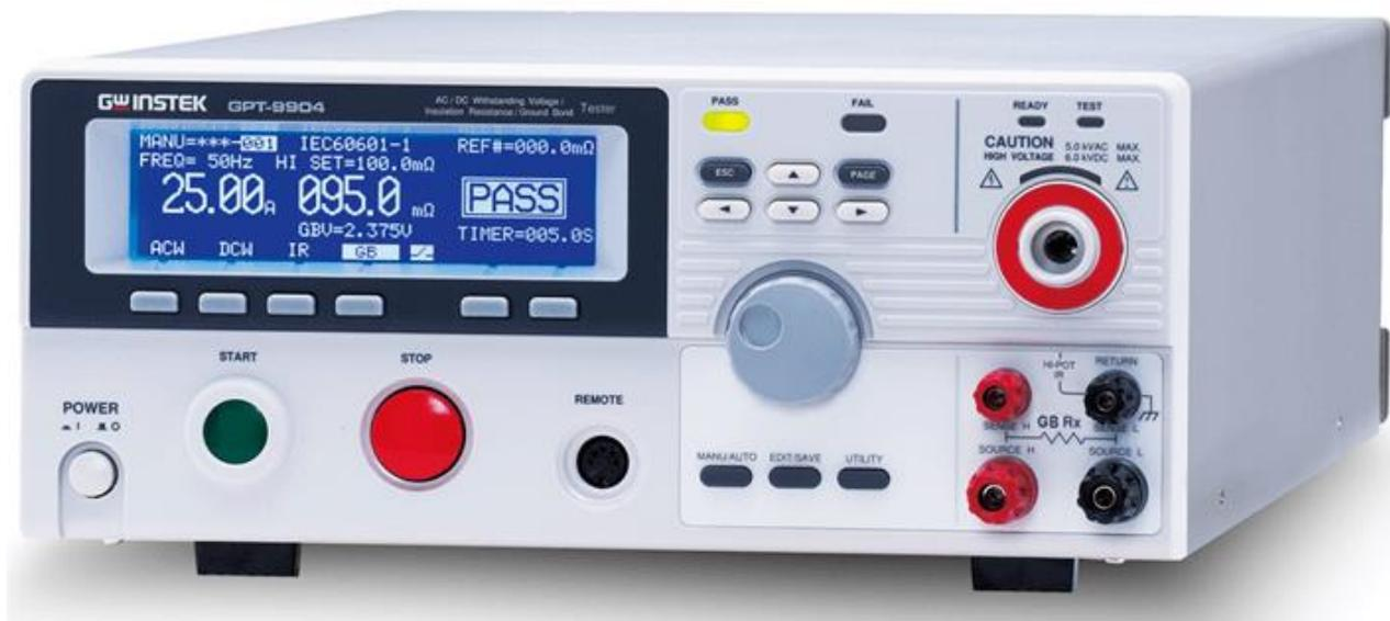
O GPT-9904 é uma plataforma de ensaios com uma potência máxima de saída de 500 VA, que realiza a grande maioria dos ensaios para verificação de conformidade com as normas IEC, EN, UL, SA, GB. Utiliza-se para ensaios em quadros elétricos (EN 61439), luminárias e outros. Testes realizados: Rigidez Dielétrica com tensão de ensaio em CA, Rigidez Dielétrica com tensão de ensaio em CC, Resistência de Isolamento e Continuidade do Circuito de Terra.
