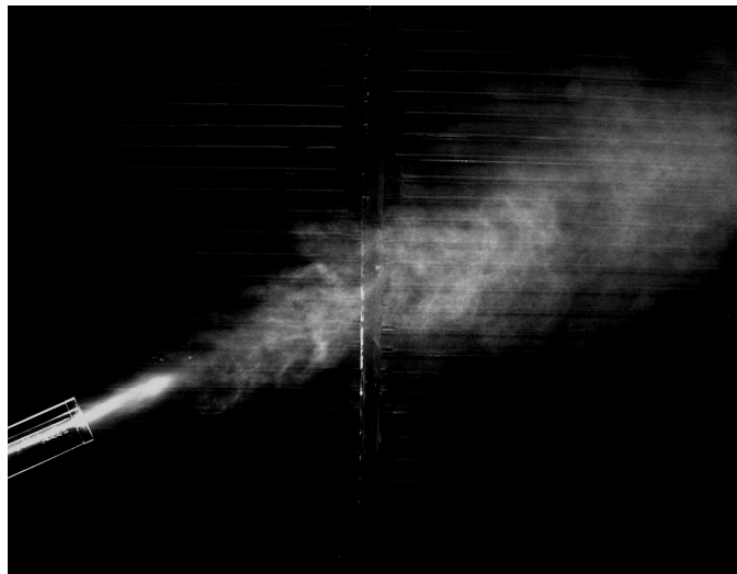
Aplicação com o injetor “UBV” de um produto à base de água (aerossol).
