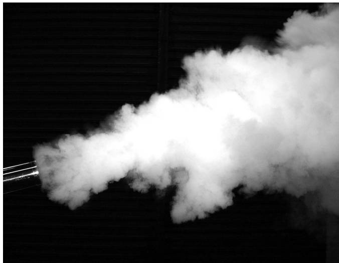
Aplicação com o injetor “FOG” de um produto à base de óleo mineral (aspecto de fumaça).
