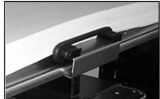
Folhas com um comprimento superior a 335 mm: a bandeja é estendida e o elevador de pacotes é fixo por baixo do extensor da bandeja. Faça deslizar o limite terminal até à parte posterior do elevador de pacotes, empurre o extensor da bandeja para dentro até o limite terminal tocar na pilha de papel.
