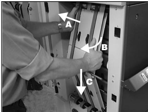
Depois de voltar a montar o transportador traseiro, assegure-se de que todas as correias transportadoras estão correctamente alinhadas.
