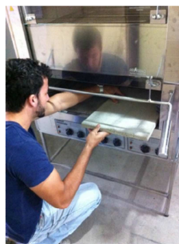
Colocando as pedras refratárias
