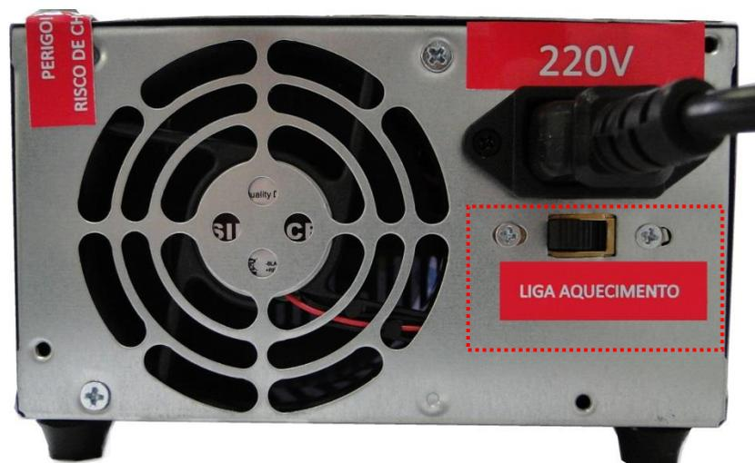
Figura 1 - Chave LIGA AQUECIMENTO, Entrada cabo alimentação 220V, Sistema de Refrigeração
