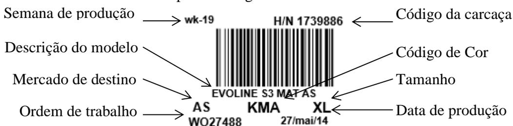
**Figura 10 – Exemplo de uma etiqueta interna.**
