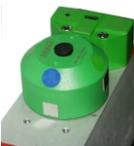
12° - verifique o funcionamento do conjunto sensor atuador, para tanto conecte a alimentação do sensor conforme o seu diagrama de conexões, verificando o acionamento do led de alimentação (o do centro),
