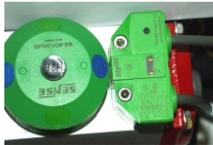
13° - com o sensor superior S1 acionado, ou seja com o alvo metálico posicionado na frente do sensor superior o seu respectivo led deve estar aceso,
