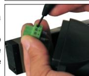
4 - Monte o conjunto válvula solenóide mais sensor com acionador, certifique-se de que os anéis de vedação estejam nos orifícios de ar da válvula, afim de evitar vazamentos.
