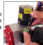
2 - Solte os dois parafusos que prendem o corpo da válvula no atuador;
