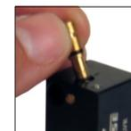
9 - Limpe com ar comprimido afim de desentupir os orifícios pneumáticos;
