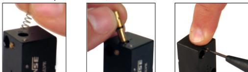
2 - Verifique os componentes internos, caso estejam em boas condições, lubrifique-os com graxa alimentícia, caso contrário, substitua-os por novos, já lubrificados de fábrica;
