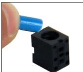
6 - Remonte o piloto pneumático, observando a correta posição dos componentes internos.
