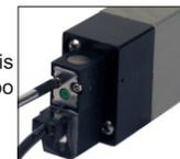
2 - Desmonte o corpo pneumático, soltando primeiro o lado do acionador manual, note que o êmbolo salta para fora devido a sua mola de retorno;
