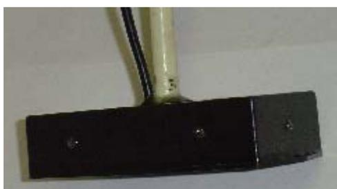
Figura 12 – Caixa preta que contém os sensores DM e CM
