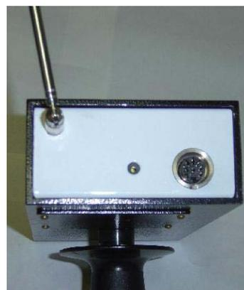
Figura 17 – Plug fêmea localizado na parte de trás do equipamento
