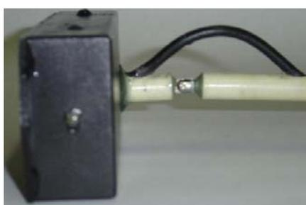
Figura 15 – Junta da haste que permite um grau de liberdade
