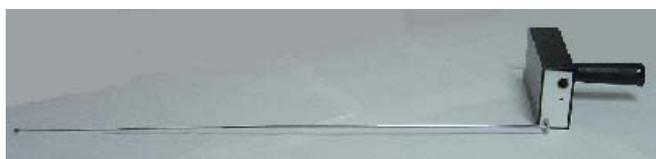
Figura 7 – Antena esticada: situação de maior alcance na detecção de campo elétrico
