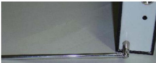
Figura 1 – Sensor detector de Campo Elétrico.
