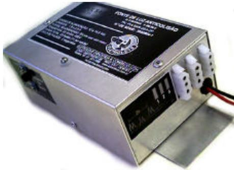
A fonte de luz anticolisão PULSAR STROBE LIGHT consiste de um conversor que transforma a tensão elétrica da aeronave (12 volts) em alta-tensão (400 volts) para o disparo de até três lâmpadas - de gás xenônio que podem ser instaladas nas pontas da asa e no topo do estabilizador vertical de aeronaves de categoria experimental. Ocorrem dois disparos seguidos nas lâmpadas das pontas da asa, que piscam juntas, e, em seguida, dois disparos na lâmpada da cauda.
