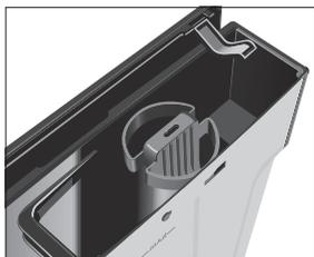
A sua Z6 não precisará de ser descalcificada se utilizar o cartucho do filtro CLARIS Smart. Caso ainda não tenha colocado o filtro na altura da primeira colocação em funcionamento, poderá fazê-lo em seguida.
