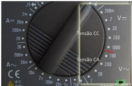
As escalas para efetuar medições em corrente contínua, no aparelho da figura, são as seguintes: 200 mV; 2 V; 20 V; 200 V; 1000 V. Em corrente alternada as escalas são: 700 V; 200 V; 20 V; 2 mV.
