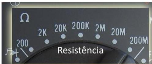
No mostrador da figura as escalas que podemos utilizar são as seguintes: 200  $\Omega$ ; 2 K $\Omega$ ; 200 K $\Omega$ ; 2 M $\Omega$ ; 20 M $\Omega$ ; 200 M $\Omega$ .
