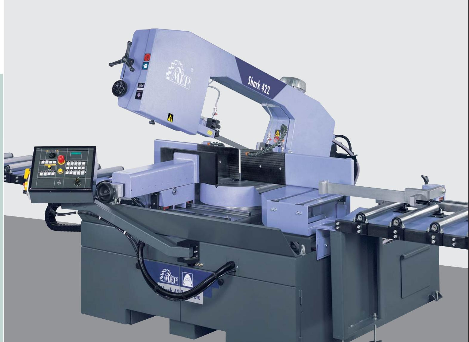
del motor de la hoja + tensado de la hoja + velocidad de la hoja + visualización numérica de la posición del cabezal.
