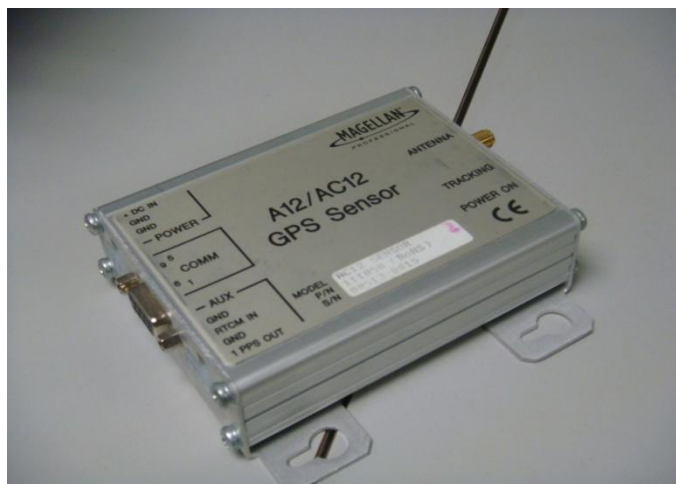
Figura 2.4 – Receptor GPS da estação do IT.
