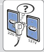
Existe uma proteção para evitar dano ao sistema elétrico da sua Lavadora.
