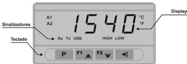
Figura 05 - Identificação das partes do painel frontal
